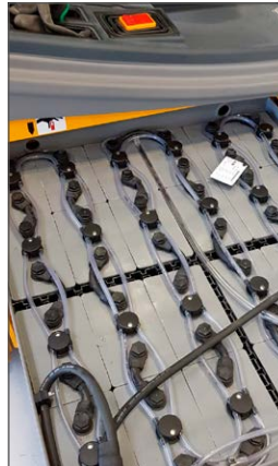
Batteria con tappi con prese per aspirazione Battery with plug with suction inlet
